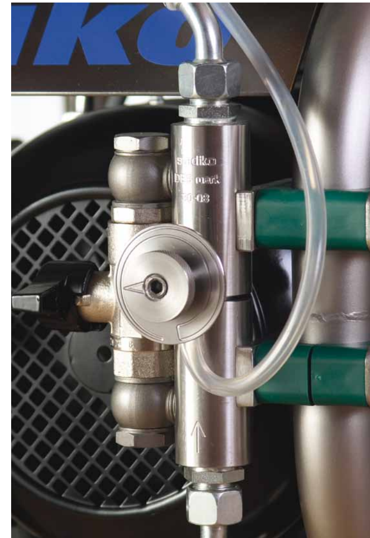
DESmark adagolóegység egy Stadiko HDVAR mobil magasnyomású berendezésen. A rozsdamentes acél gyorscsatlakozókkal a fixen telepített rendszerekbe is beépíthető a mosó-leállásoknál.
