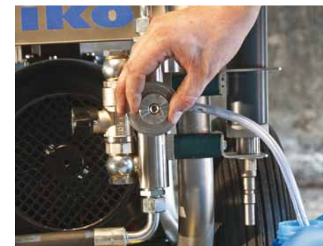
Az állítógombbal fokozatmentesen beállítható a kívánt vegyszermennyiség.
