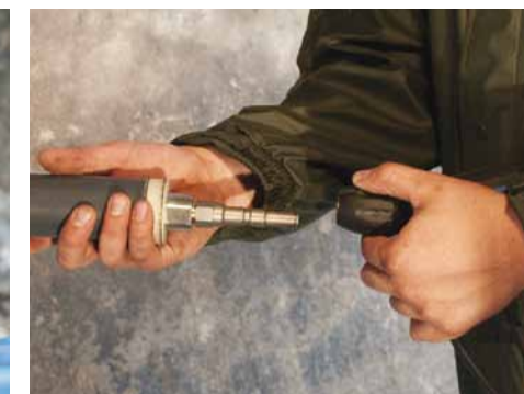
A hablándzsa gyorscsatlakozóval csatlakoztatható az adagolópisztolyra.
